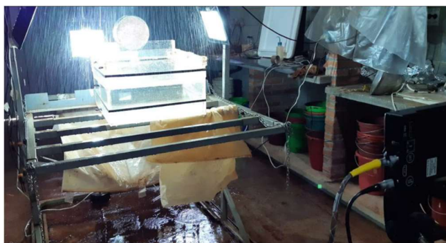
Figura 4. Aparelho Simulador de Chuva Fonte: Merabet (2022).
