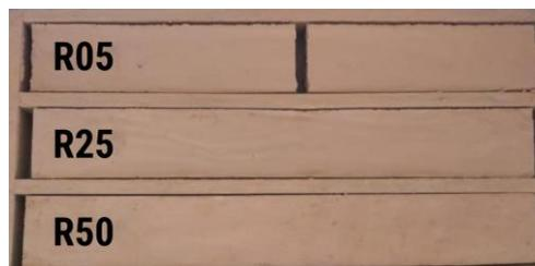
Figura 9. Ensaio de retração: solo-gesso reciclado.
