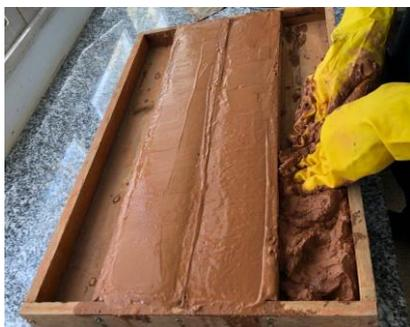
Figura 4. Representação do processo de acomodação das misturas na caixa de ensaio de retração.
