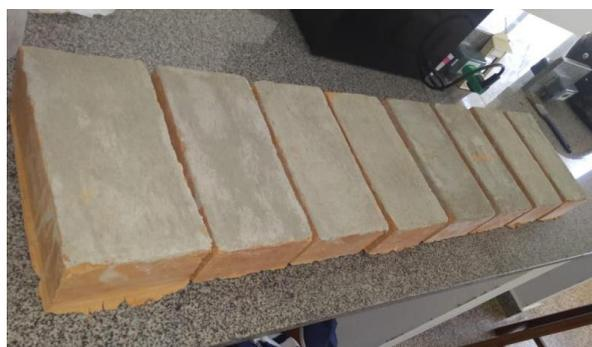
Figura 3. Aspecto dos blocos após o capeamento.
