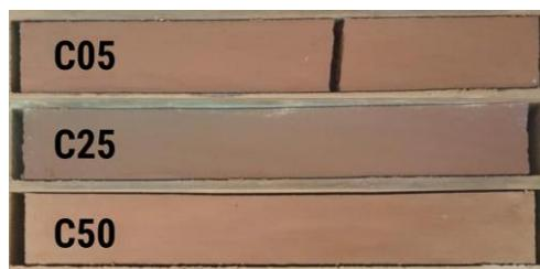
Figura 8. Ensaio de retração: solo-gesso comercial.
